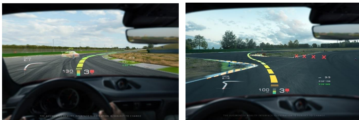
Figura 13. Head Up Display di tipo olografico proposto da Porsche (Fonte: Porsche ).
