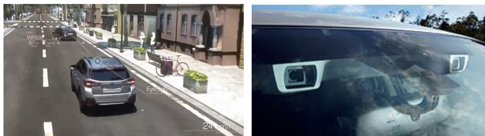
Figura 4. Sistema di sicurezza di Livello 2 di Subaru (fonte: Subaru ).
