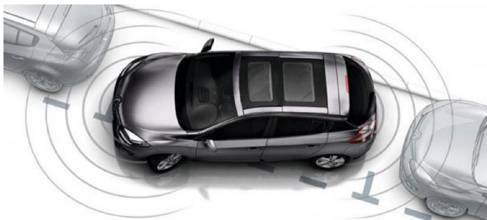
Figura 1. Raggio di azione dei sensori di parcheggio (Fonte: Motor1 ).
